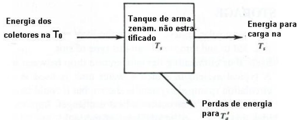
Figura 2.15 - Tanque não estratificado de estocagem de massa m dependente da Temperatura T_s em ambiente de Temperatura T_a
